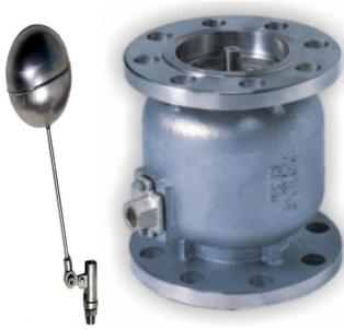
La válvula de flotador tiene un interruptor-flotador para controlar la válvula principal. Cuando el agua en el depósito alcanza el máximo nivel regulado, el interruptor-flotador cierra la cámara de presión de la válvula para acumular presión rápidamente, es decir, empuja la pistón a cerrar para controlar el nivel de agua. Para economizar espacio en el estanque y facilitar a mantener, recomendamos que instala esta válvula fuera del estanque.
