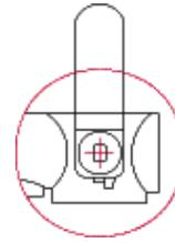
Cuando el mango es girado hacia arriba, el conjunto de válvula reductora de presión está en el estado abierto de la presión reductora.
