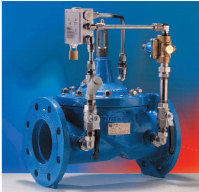
La junta de cierre, sobre el asiento de la válvula, garantiza un sellado perfecto y duradero y permite que la válvula de control actúe al mismo tiempo como válvula de cierre perfecto antigoteo. El circuito piloto va equipado con un filtro, que asegura que la válvula piloto no se obstruirá; además la válvula no necesita lubricación, tiene una construcción sencilla y por lo tanto requiere poco mantenimiento.
